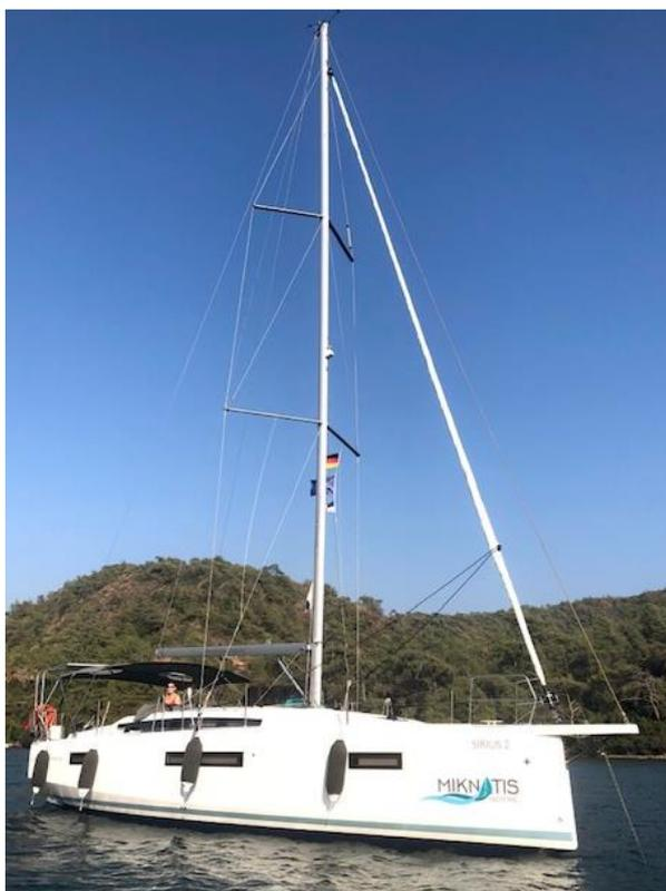
Unser **Charterschiff** ‚SIRIUS 2‘: Sun Odyssey 410, Bj. **2022**, L.: 12,95, B.: 3,99, Tiefgang: 1,95; Gewicht: 7.8 t, Motor: 45 PS, 2 Seitenruder, Bugstrahlruder; 100 m Ankerkette, Rollgroß, Solarzellenpanel, eine Vorder- und zwei Backskajüten, zwei Nasszellen, Frischwassertanks: 530 l, elektrische Winschen.
